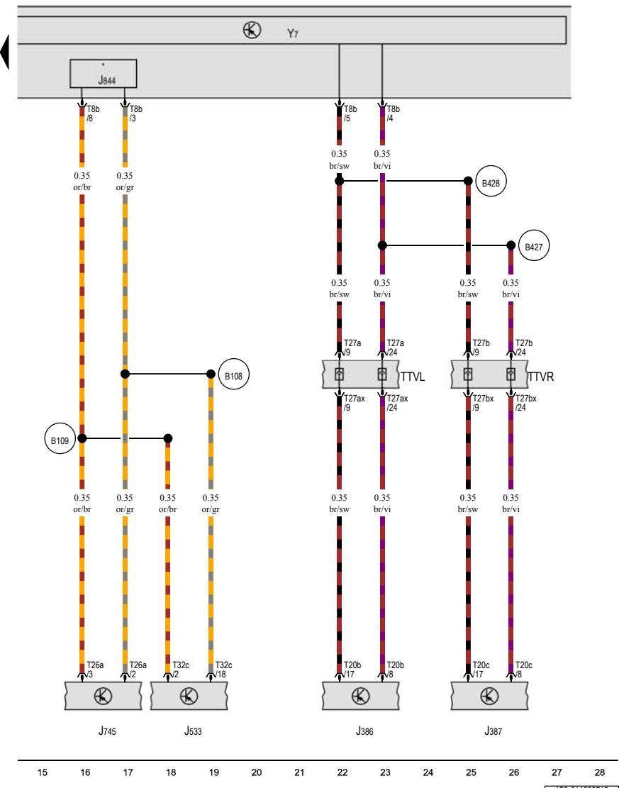
远光灯辅助系统控制单元, 自动防眩的车内后视镜
